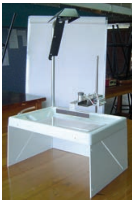
Fig. 2. Cubeta de ondas.
