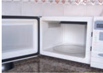
Fig.15. La longitud de onda de las microondas es mucho mayor que el diámetro de los orificios o ranuras de la protección que tienen las puertas. De esa forma las microondas no atraviesan la puerta.
