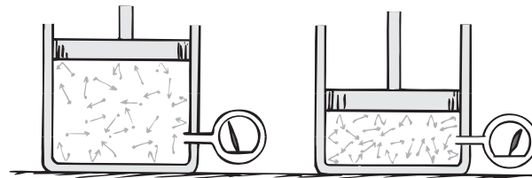
FIGURA 14.13 Cuando disminuye el volumen de gas, aumentan la densidad y, en consecuencia, la presión.
