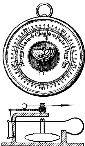
FIGURA 14.10 Un barómetro aneroida (arriba) y su corte transversal (abajo).
