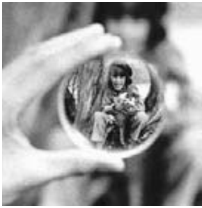
FIGURA 28.50 Una lente divergente forma una imagen virtual y derecha de la niña y su mascota.
