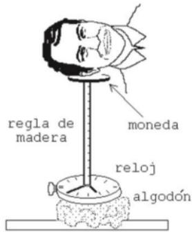
Un experimento fácil de realizar y que ilustra la buena transmisión del sonido a través de un sólido, es colocar un reloj sobre un trozo de algodón, y encima de él una varilla de madera con una moneda en el extremo. Al colocar la oreja sobre la moneda se escucha nítidamente el tic-tac del reloj, mucho mejor que a través del aire.
