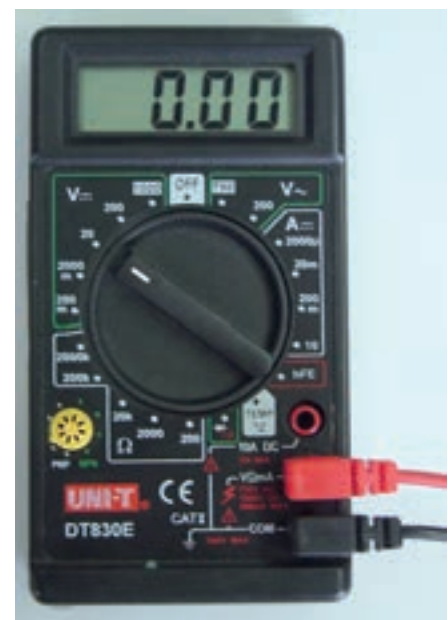
Fig. 23b. Multímetro preparado para medir ddp de corriente continua. El valor máximo que puede medir en esta posición de la llave selectora es de 20V
