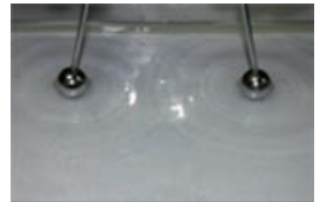
Fig.17. Dos focos puntuales generando ondas circulares en la cubeta.
