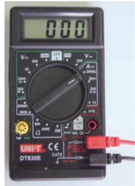
Fig. 23a. Multímetro preparado para medir intensidad de corriente continua. El valor máximo que puede medir en esta posición de la llave selectora es de 2000\mu\text{A}
