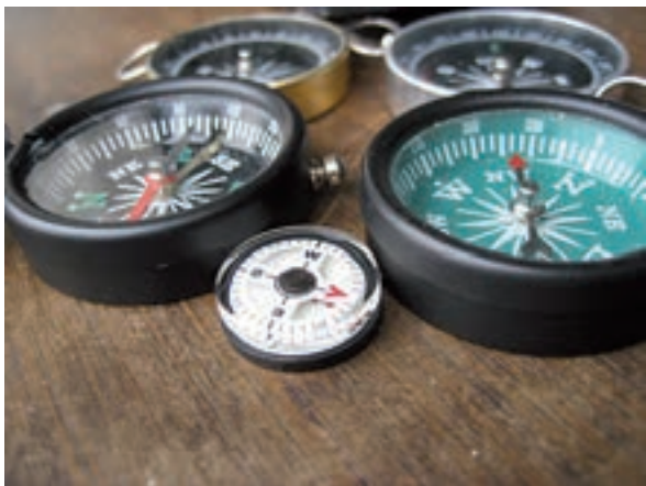
Fig.8. Brújula. Se orienta siguiendo al campo magnético que le rodea.
