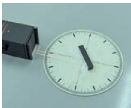
Fig. 1a. Reflexión de un haz de luz en un espejo plano.
