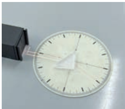
Fig. 2a. Cambio de dirección de un haz de luz al cambiar de medio.
